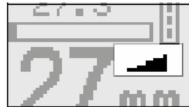
一般的には、金属がないところではゆっくりとしたカチカチという音が出るように感度を設定します。このレベルに感度を設定しておけば、異なった深さにある同じ寸法の鉄筋の違いを即座に判断することができます。
